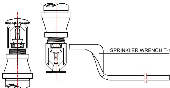
**FIGURE D : SPRINKLER WRENCH SELECTION & USE**
